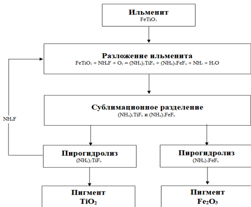
Рисунок 5 - Фтораммонийная технология получения диоксида титана
