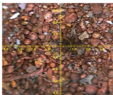
Рисунок 4 -Металлическая медь, полученная после выщелачивания лома латуни серной кислотой без перекиси водорода (La-405)
