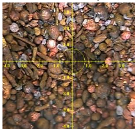
Рисунок 6 - Металлическая медь, полученная после выщелачивания лома латуни серной кислотой и перекисью водорода (La-313)
