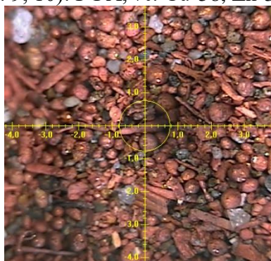
Рисунок 9 - Металлическая медь, полученная после выщелачивания лома латуни серной кислотой (La-701)
