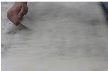
Рисунок 5. Выкладка четырёх тонких слоёв шерсти, разложенных перпендикулярно друг к другу
