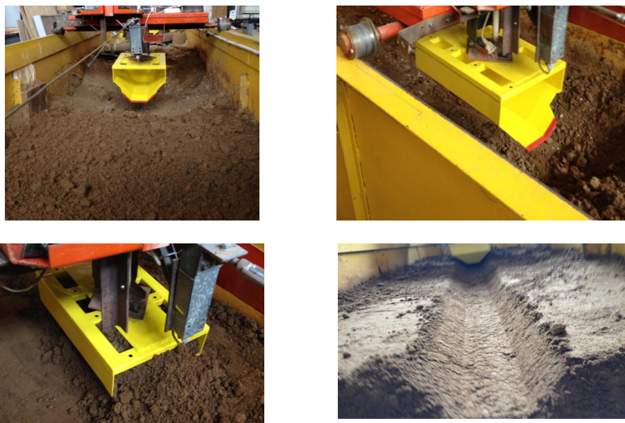
Рисунок 2 – Испытание модели рабочего органа каналоочистителя – ковша трапецидального профиля в лабораторных условиях
