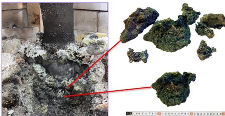
Рисунок 14. Полученные спекшиеся материалы вокруг электрода
