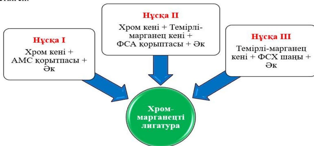
Сурет 4 – Cr–Mn кешенді лигатурасын арудың технологиялық сұлбасы
