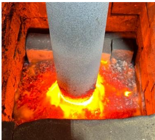
Рисунок 15. Процесс синтеза вид колошника печи с дробленой шихтой
