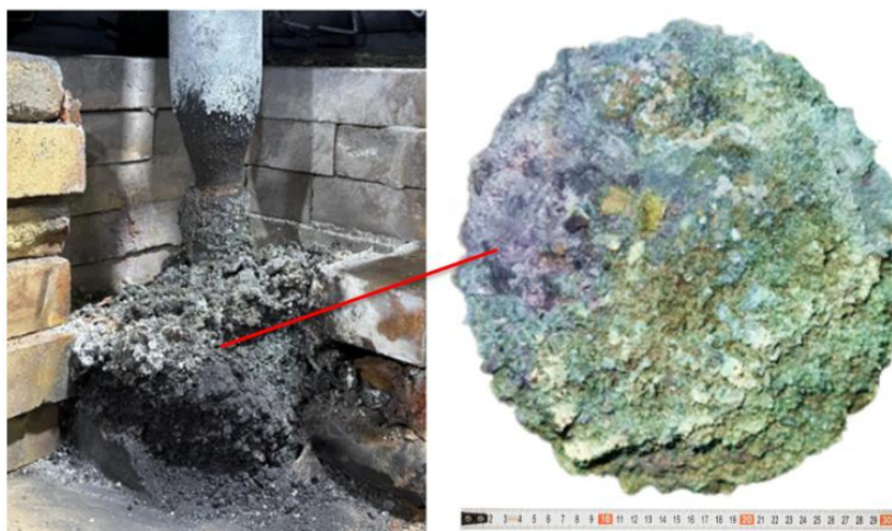
Рисунок 17. Полученные спекшился материалы вокруг электрода
