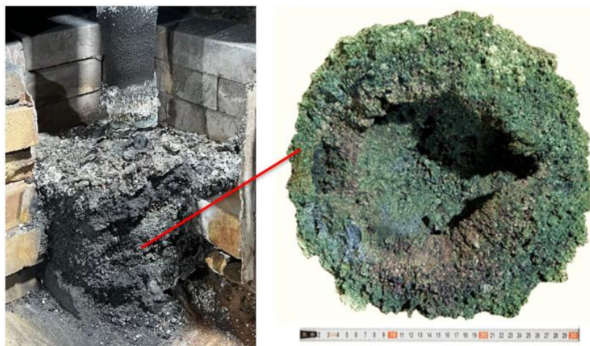
Рисунок 16. Полученные спекшиеся материалы вокруг электрода
