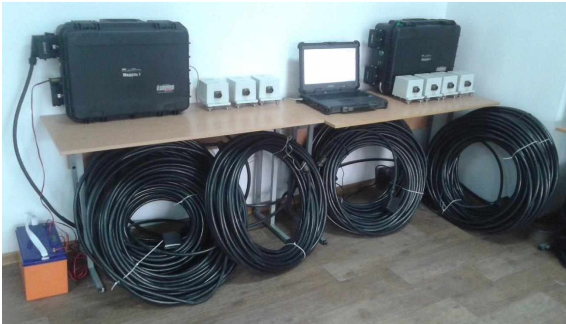
Рисунок 2 – Общий вид измерительно-вычислительного комплекса «ДИНАМИК» для динамических испытаний конструкций искусственных сооружений (мостов, путепроводов, виадуков, эстакад и т.д.)
