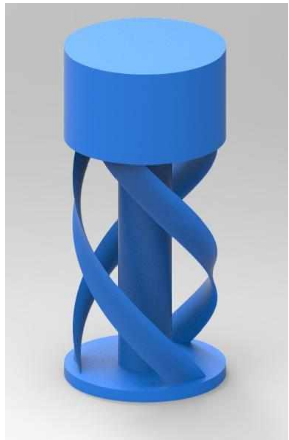
Рисунок 3 - Ветряные турбины с вертикальной осью (VAWT) 3D модель
