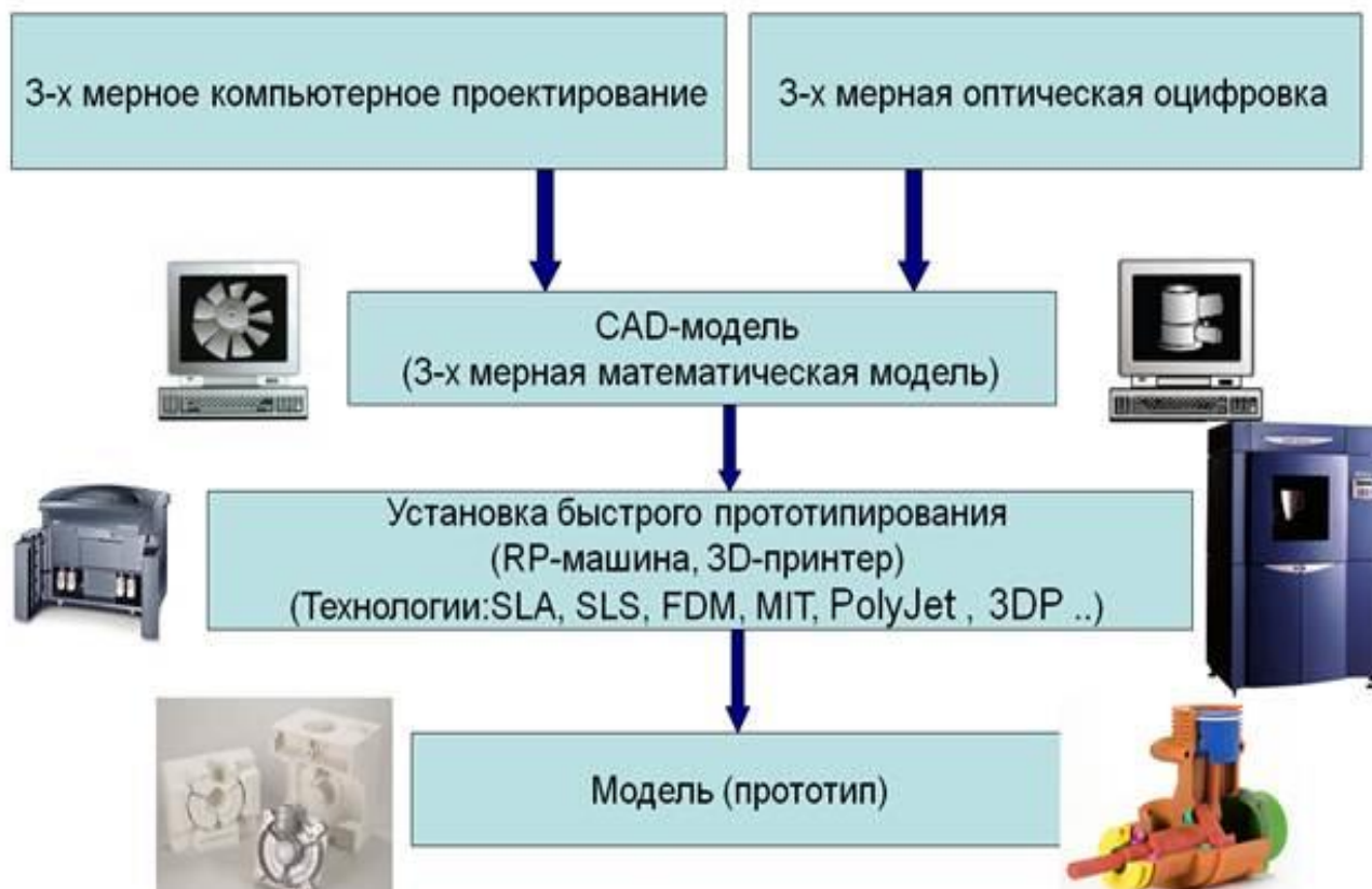
Рисунок 1 - Технология быстрого прототипирования (Rapid Prototyping)
