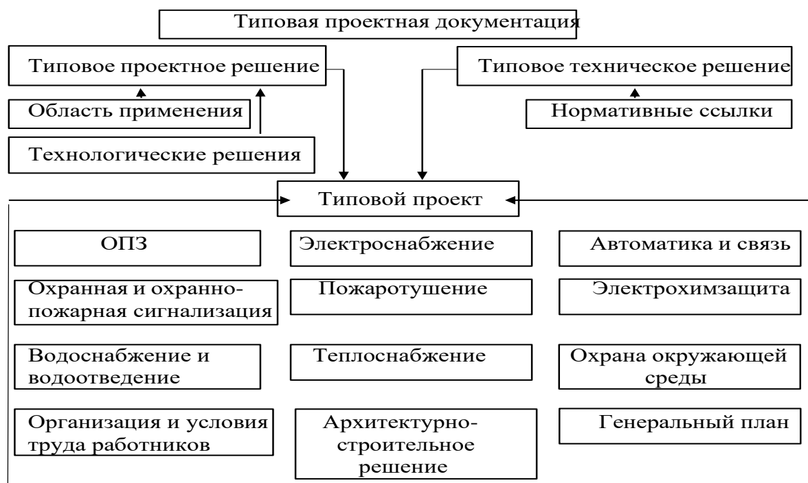
Рисунок 1. Структура типовой проектной документации объектов магистрального нефтепроводного транспорта.
